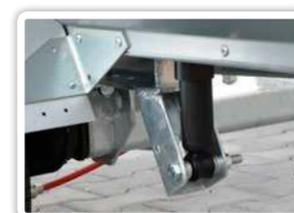
2. mit zwei hydraulischen Stoßdämpfern wird die verzinkte Kippbrücke in Schräglage abgesenkt.
