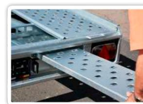
3. Auffahrschiene aus dem Aufnahmefach entnehmen und am Rahmen fixieren.
