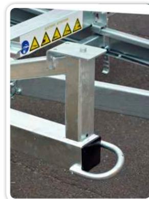
➔ inklusive Windenstand und robustem Schwerlaststützrad
